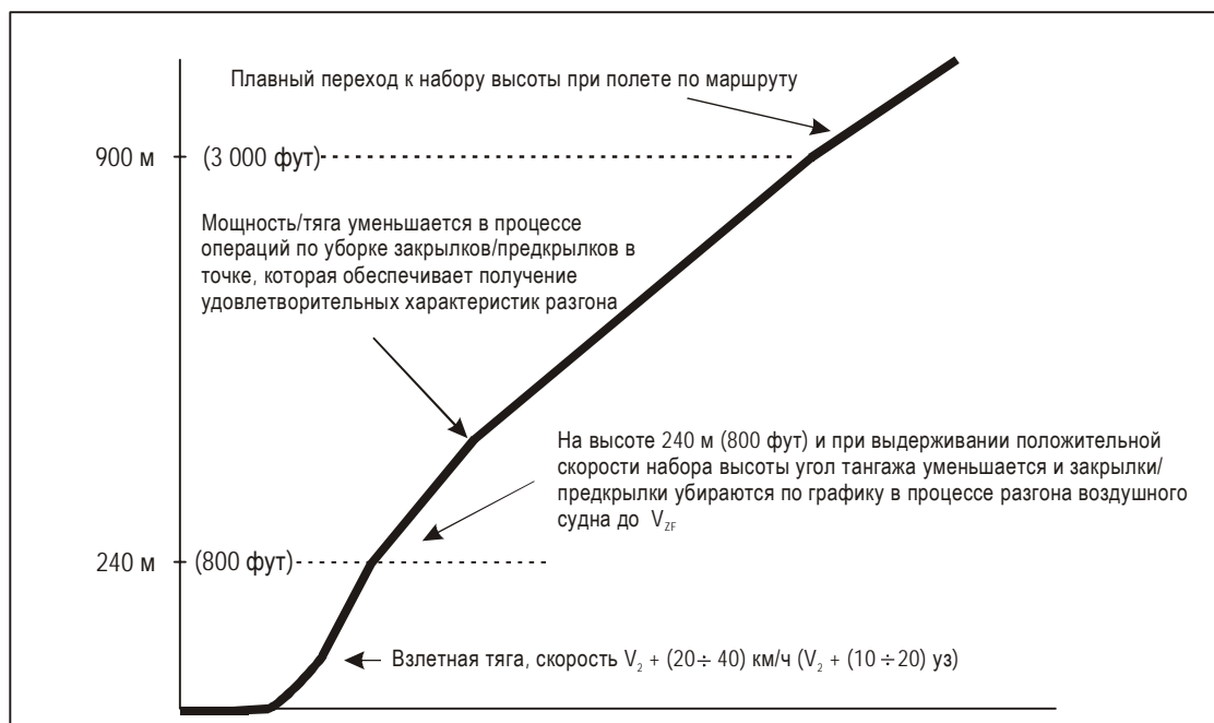
Рис. I-7-3-Доб-2. Снижение шума при наборе высоты во время вылета. Пример метода уменьшения воздействия шума на удалении от аэродрома (NADP 2)
