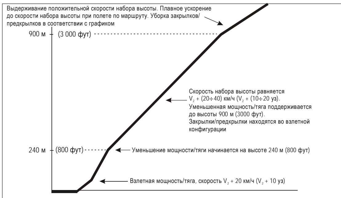
Рис. I-7-3-Доб-1. Снижение шума при наборе высоты во время вылета. Пример метода уменьшения воздействия шума вблизи аэродрома (NADP 1)
